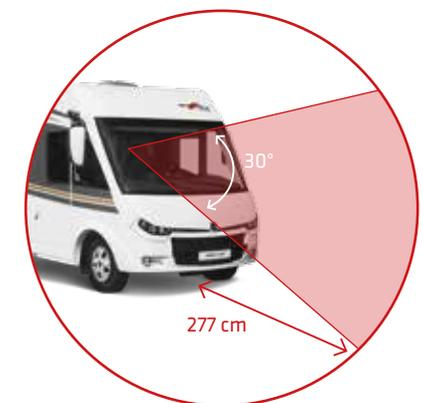
^ Bestwert für die Sicht nach vorn: Sichtkontakt zur Fahrbahnoberfläche bereits nach 2,77 m – das ist Bestwert unter integrierten Reisemobilen.
