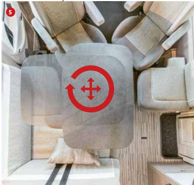
^ Wohnraumbtisch 360° drehbar und zusätzlich per Fußpedalbedienung 2-fach verschiebbar. Optimale Integration aller Sitzplätze am Tisch.
