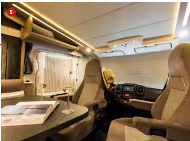
^ Das Hohlwaben-Isolierfrontscheibenplissee kann dank Vertikalbedienung zur Verdunkelung oder zum Sichtschutz eingesetzt werden. Die Hohlwaben isolieren, so dass keine Kälte durch die große Frontscheibe in den Wohnraum zieht.
