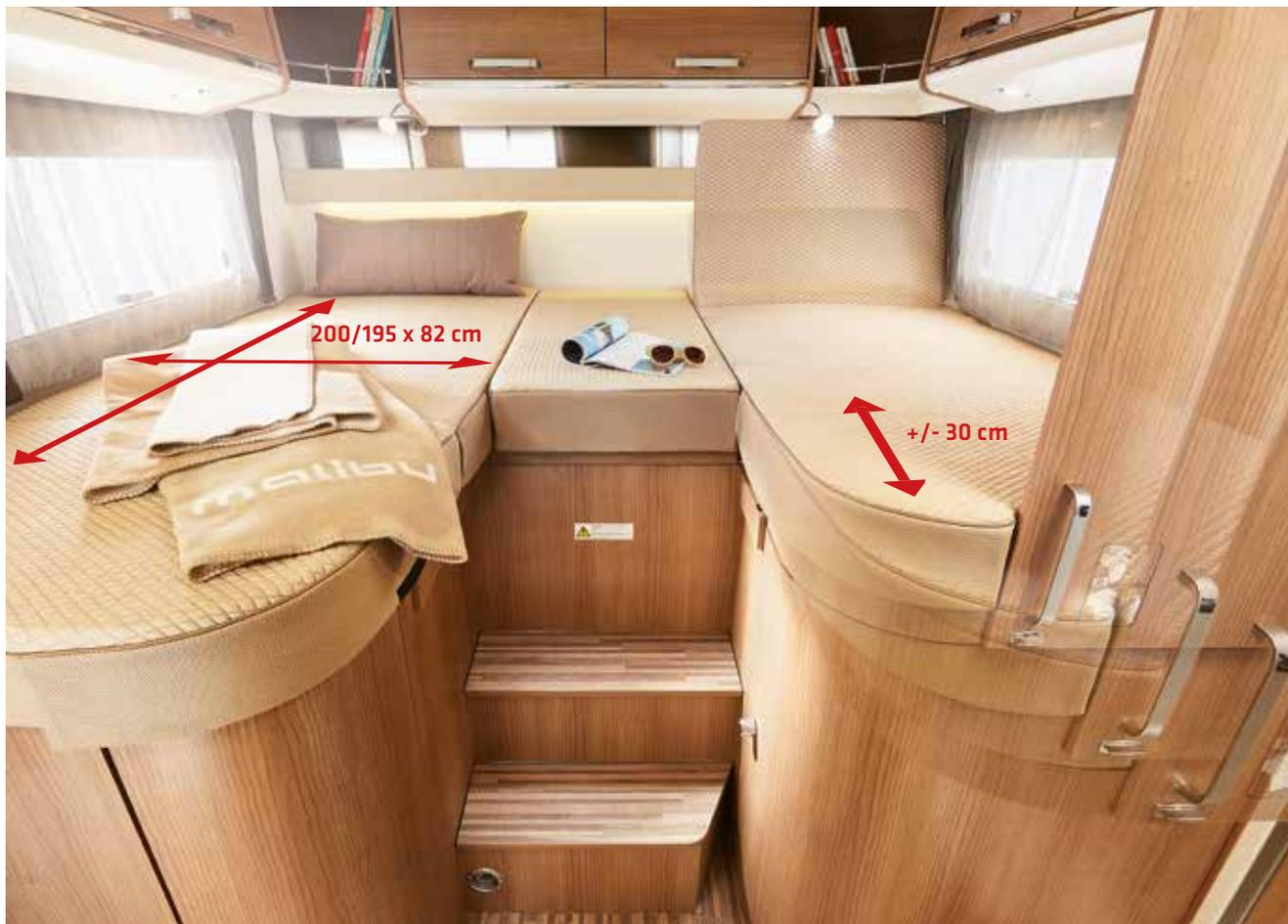
^ Beim Modell 440 LE lässt sich das Einzelbett auf der Fahrerseite um bis zu 30 cm ausziehen. So werden große Liegeflächen mit höchstem Komfort bei kompakten Außenlängen verbunden.
