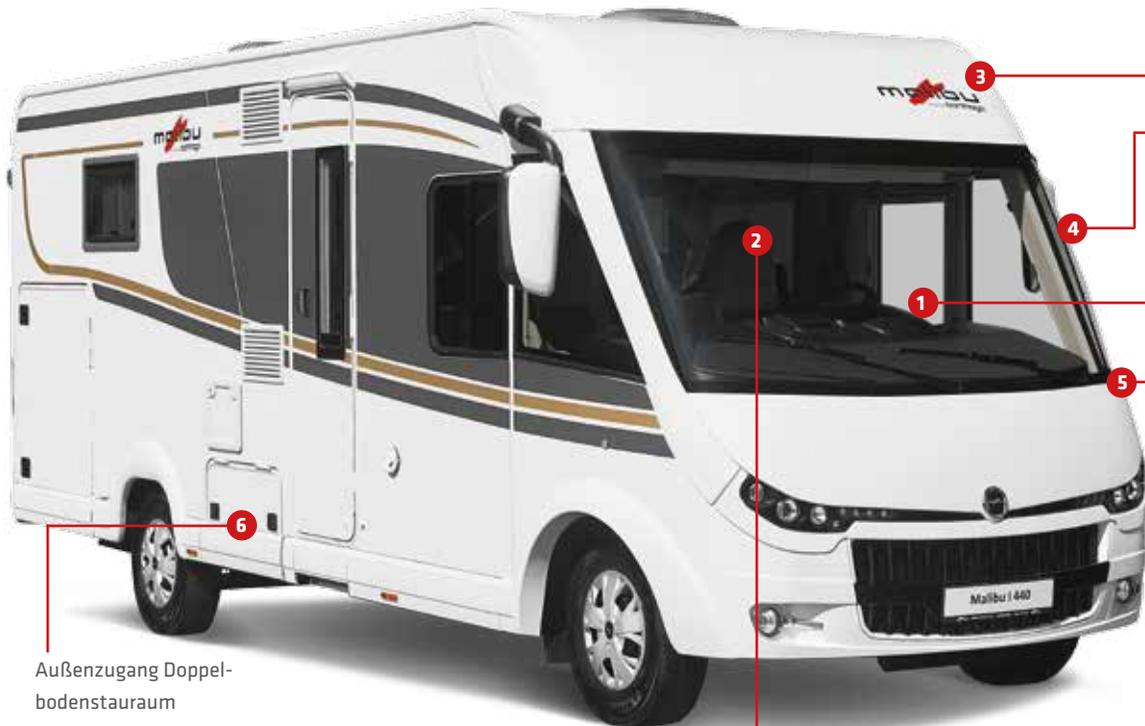
3-dimensional geformte Front und ein flacher Anstellwinkel bedeuten geringen Luftwiderstand und reduzierten Kraftstoffverbrauch.
