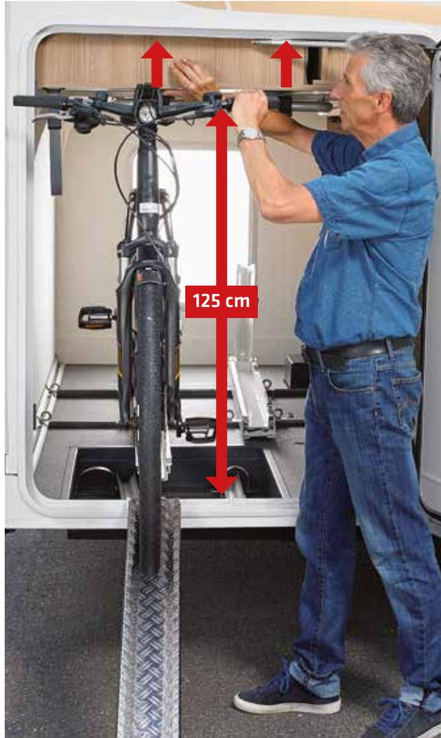
Erweiterung der Beladungshöhe durch einfaches Hochschwenken des innenliegenden Heckbetts mit einer Hand und zusätzliche abgesenkte Bodenmulde (somit Lenkerhöhe Pedelec bis 125 cm möglich)
