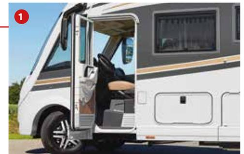
^ Fahrertür mit niedrigem Türeinstieg und Sicherheitsdoppelverriegelung.
